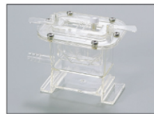
워터자켓 (Water Jacket) 샘플온도 유지 또는 변화를 위한 장치
